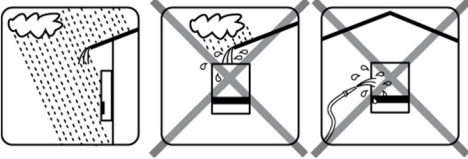
Figura 2.1 Evitare un contatto continuo con acqua
