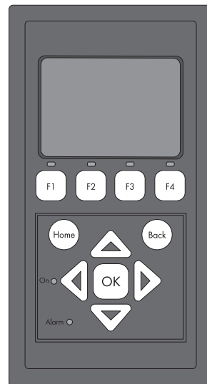
Figura 3.1 Panoramica dei pulsanti del display e relative funzioni
